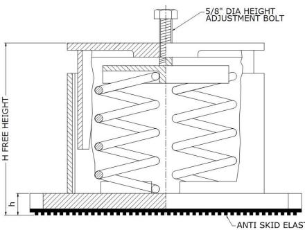
ANTI SKID ELASTOMERIC ACOUSTICAL PAD
